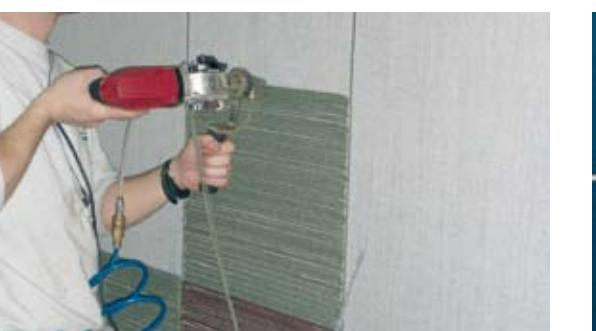
**8. Fabricación sobre telar** | Tufting on the loom | Fabrication sur le métier
